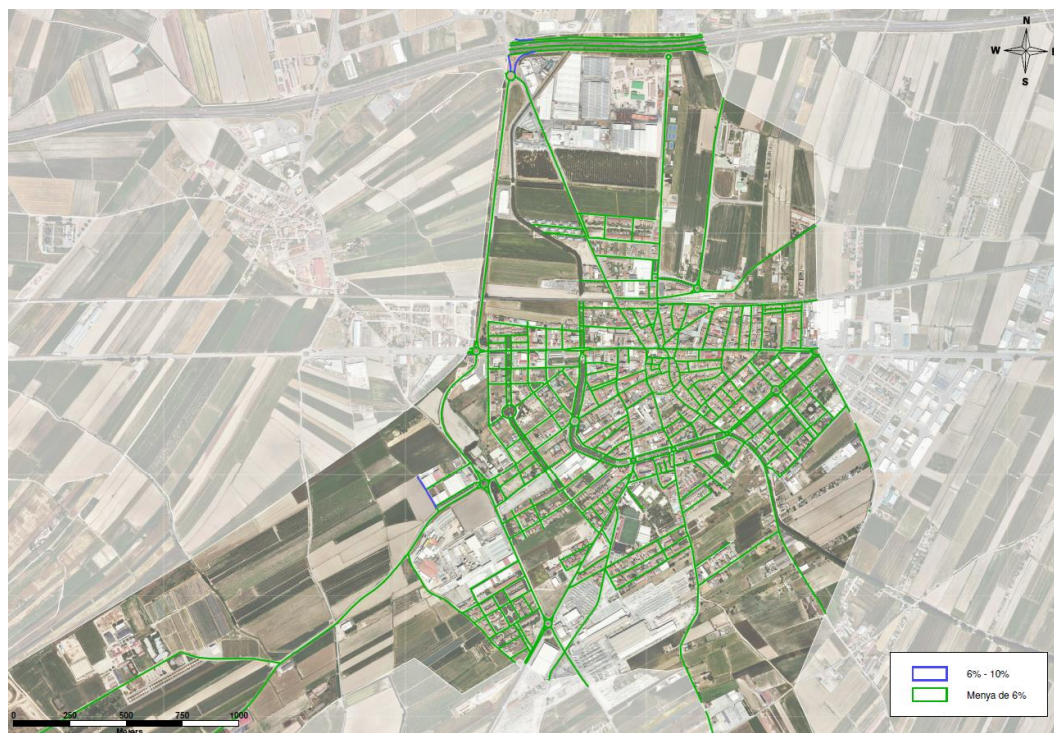
Figura 4.12.— Pendents xarxa viària. Font: elaboració pròpia
